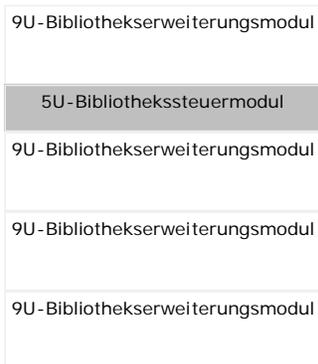
**⚠️ Warnung:** Alle Bibliotheken, die größer als 14U sind, müssen in einem Rack installiert werden, das über eine Schutzdeklekme (Masseklemme) verfügt. Zudem muss die Spannungsversorgung über einen Industrienorm-Stecker und eine Industrienorm-Steckdose und/oder einen Appliance-Koppler gemäß IEC 60309 (oder einer entsprechenden Landesnorm) erfolgen und einen Schutzleiter mit einem Querschnitt von mindestens  $1,5 \text{ mm}^2$  (14 AWG) aufweisen.
